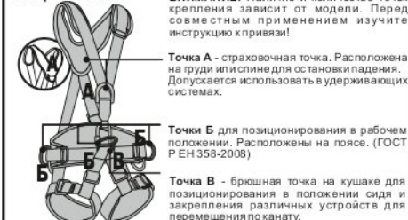
Рис. 5. Способы крепления к анкерным устройствам
