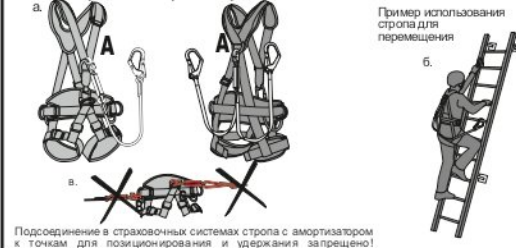
Рис. 6. Использование карабинов, входящих в состав стропов
