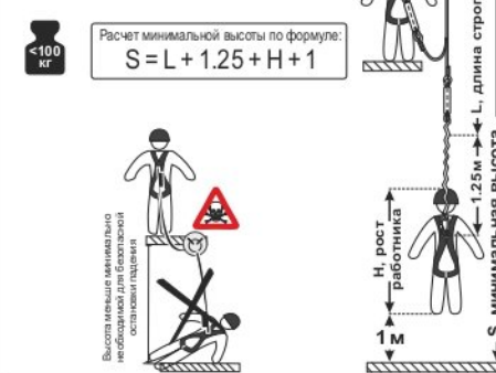
Рис. 9. Способы крепления к анкерным устройствам
