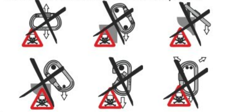
Рис. 4. Опасные способы использования карабинов
