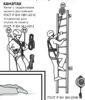
Рис. 10. Позиционирование на канатах
