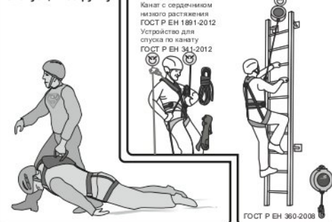
Рис. 9. Способ эвакуации за ручку
