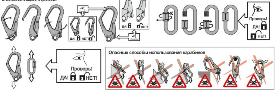
Рис. 7. Способы крепления стропов к анкерным устройствам
