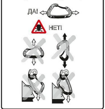
Рис. 6. Приложение нагрузки к карабинам
