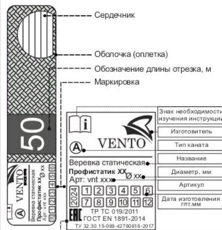
Рис. 1. Составные части и маркировка изделия
