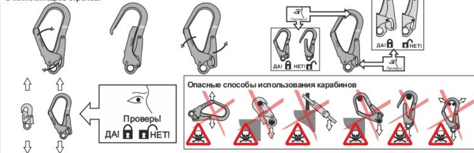
Рис. 6. Способы крепления стропов к анкерным устройствам
