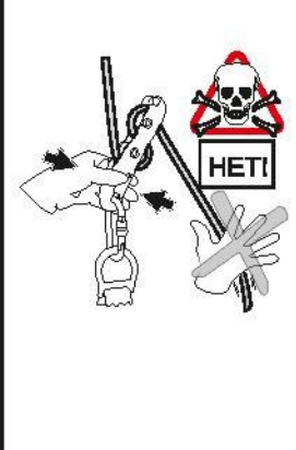
Рис. 13. Подъем с использованием зажима со стременом
