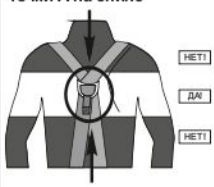
Рис. 7. Правильное положение страховочной точки А на спине
