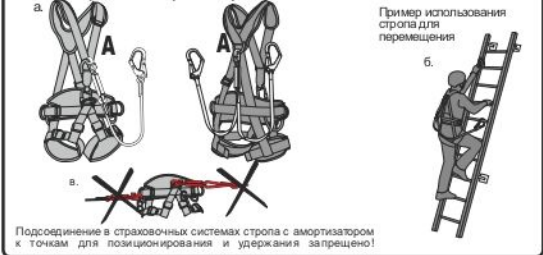
Рис. 6. Использование карабинов, входящих в состав стропов
