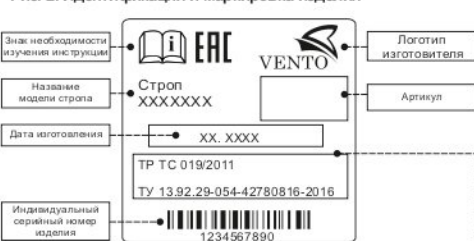
Рис. 2. Идентификация и маркировка изделия
