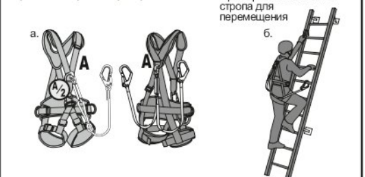
Рис. 4. В страховочных системах допускается использование только стропы с амортизатором рывка
