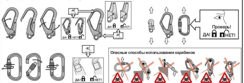
Рис. 6. Краткая пиктографическая информация по использованию карабинов, входящих в комплектацию стропов.
