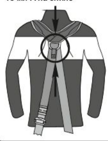
Рис. 10. Правильное положение страховочной точки А на спине
