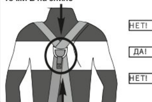
Рис. 6. Правильное положение страховочной точки В на спине
