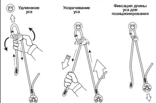
Рис. 9. Регулировка длины уса самостраховки в процессе использования
