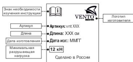
Рис. 2. Идентификация и маркировка изделия
