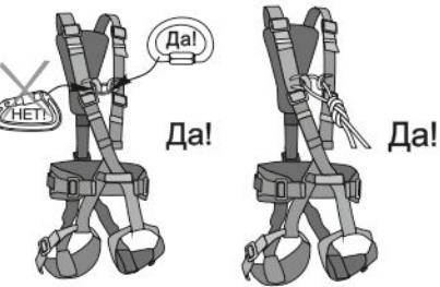
Рис. 9. Способ эвакуации за ручку
