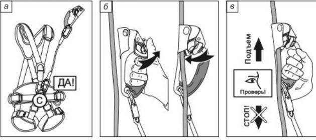
**Рис. 6. Положение жумара на вертикальных перилах**
