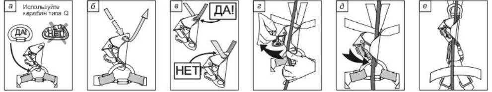
**Рис. 5. Установка жумара на канат**
