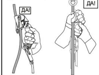
**Рис. 7. Правильное положение жумара при движении по наклонным перилам**
