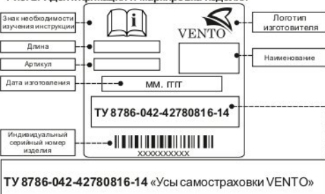
Рис. 2. Идентификация и маркировка изделия
