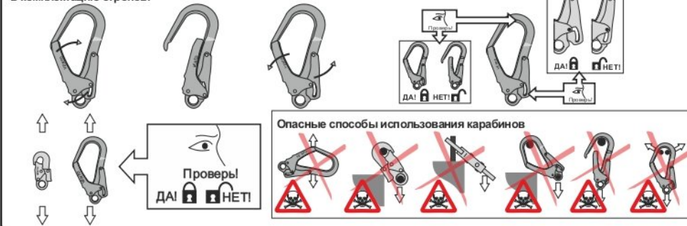
Рис. 6. Способы крепления стропов к анкерным устройствам
