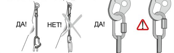
Рис. 6. Использование оттяжек с рапидами «Link 8»
