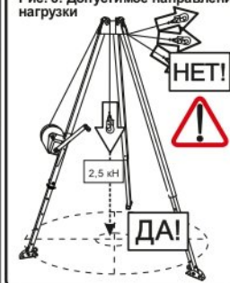
Рис. 8. Допустимое направление нагрузки
