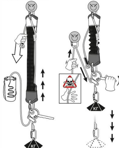
Рис. 8. Использование при натяжении гибких анкерных линий
