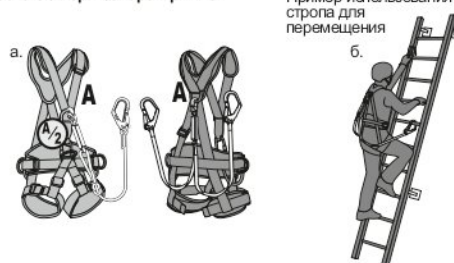
Рис. 4. В страховочных системах допускается использование только стропы с амортизатором рывка
