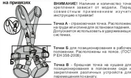
Рис. 5. Способы крепления к анкерным устройствам
