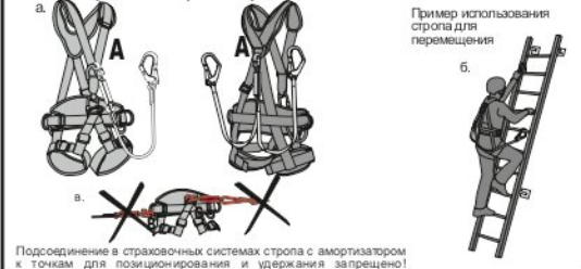
Рис. 6. Использование карабинов, входящих в состав стропов
