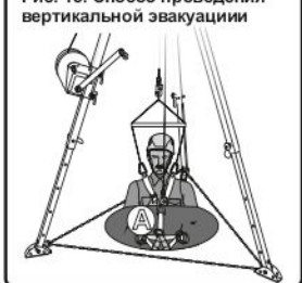
Рис. 15. Способ проведения вертикальной эвакуации
