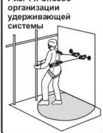
Рис. 14. Способ организации удерживающей системы
