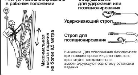
Рис. 16. Пример организации системы канатного доступа
