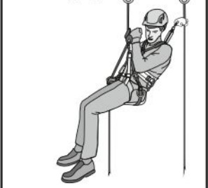
Рис. 16. Пример организации системы канатного доступа
