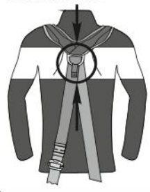
Рис. 9. Правильное положение страховочной точки А на спине
