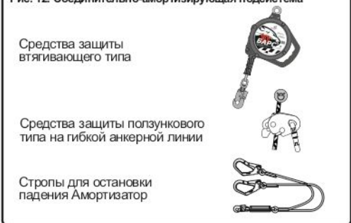
Рис. 14. Способ организации удерживающей системы
