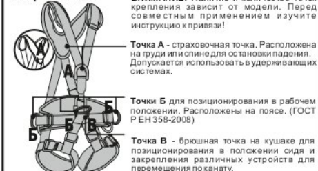
Рис. 5. Способы крепления к анкерным устройствам
