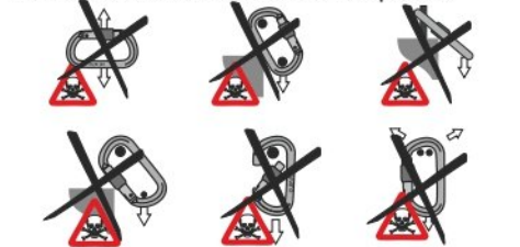
Рис. 4. Опасные способы использования карабинов
