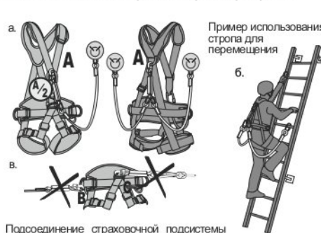
Рис. 8. Использование стропы с амортизатором рывка
