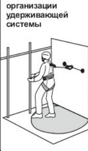
Рис. 12. Способ организации удерживающей системы
