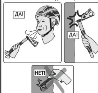
Рис. 10. Очистка ледобура от керна
