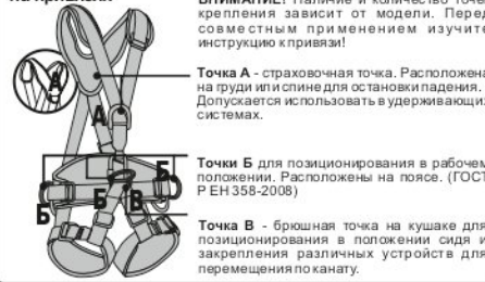
Рис. 5. Способы крепления к анкерным устройствам
