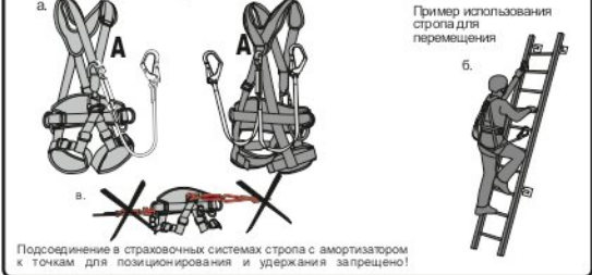
Рис. 6. Использование карабинов, входящих в состав стропов
