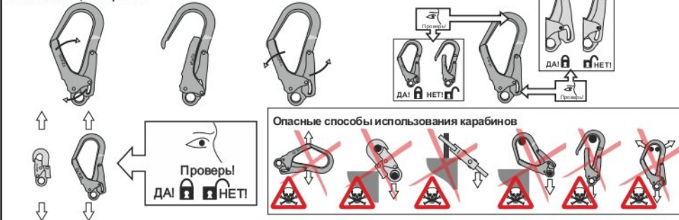
Рис. 6. Способы крепления стропов к анкерным устройствам
