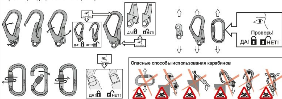
Рис. 6. Краткая пиктографическая информация по использованию карабинов, входящих в комплектацию стропов.
