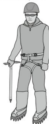
Рис. 5. Ледоруб в положении «трость»
