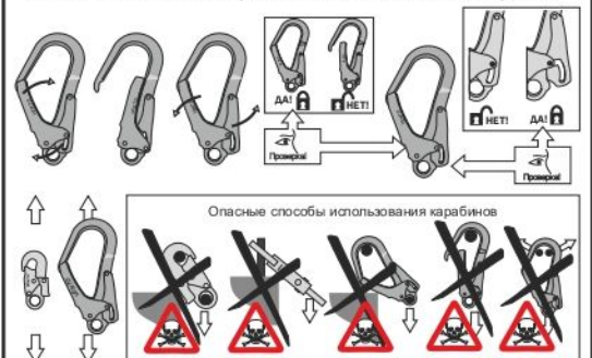
Рис. 8. Ограничения по использованию стропов с амортизатором
