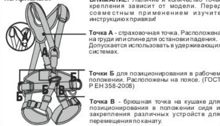
Рис. 5. Способы крепления к анкерным устройствам
