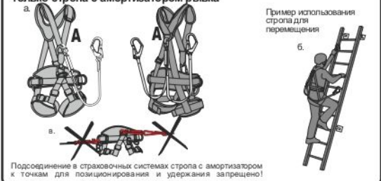
Рис. 6. Использование карабинов, входящих в состав стропов
