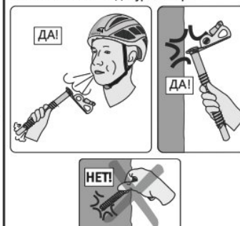
Рис. 10. Очистка ледобура от керна
