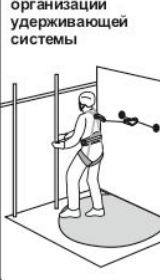
Рис. 10. Способ организации удерживающей системы
