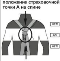
Рис. 6. Правильное положение страховочной точки А на спине
