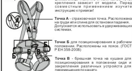
Рис. 5. Способы крепления к анкерным устройствам
