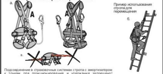
Рис. 6. Использование карабинов, входящих в состав стропов
