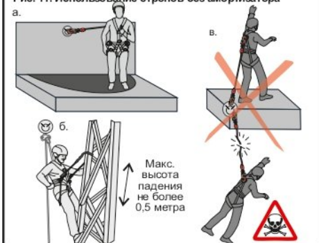
Рис. 11. Использование стропов без амортизатора
