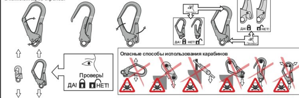
Рис. 6. Способы крепления стропов к анкерным устройствам
