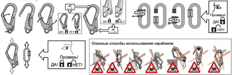
Рис. 7. Способы крепления стропов к анкерным устройствам
