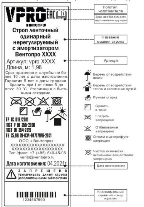
Рис. 2. Идентификация и маркировка изделия (пример)
