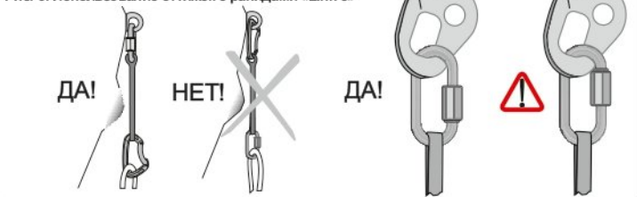
Рис. 6. Использование оттяжек с рапидами «Link 8»
