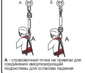
Рис. 5. Общие принципы использования карабинов
