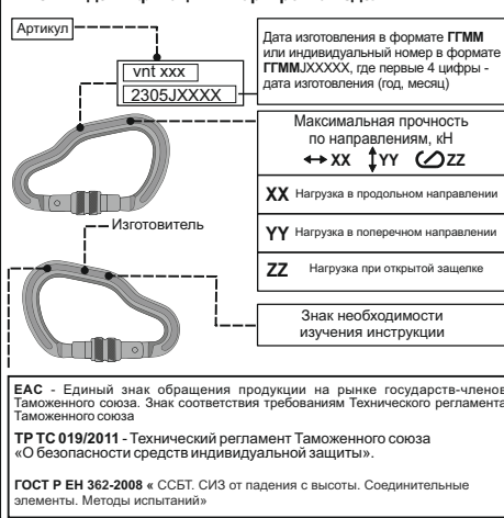
Рис. 3. Приложение нагрузки к карабину
