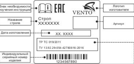
Рис. 2. Идентификация и маркировка изделия
