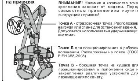
Рис. 5. Способы крепления к анкерным устройствам
