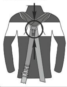
Рис. 10. Правильное положение страховочной точки А на спине
