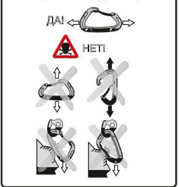
Рис. 6. Приложение нагрузки к карабинам
