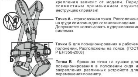
Рис. 5. Способы крепления к анкерным устройствам
