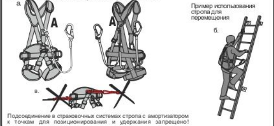
Рис. 6. Использование карабинов, входящих в состав стропов
